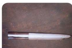
Matériel de prélèvement des noix dans les sacs : une sonde à sac
